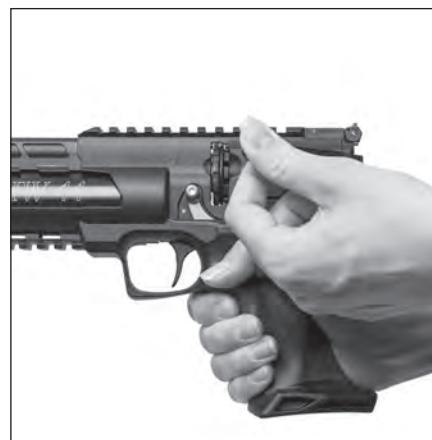
**Attention!** La chambre du chargeur, ouverte latéralement «côte A», doit être dirigée vers l'arrière.
