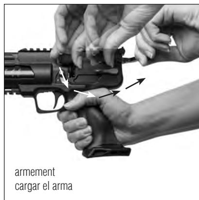
Pendant l'armement, le chargement et la fermeture, il ne doit **pas** y avoir de doigts, vêtements ou autres choses sur ou à proximité de la détente et de la sûreté. Portez **toujours** des lunettes de tir de sécurité.
