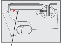
Рычаг предохранителя (переднее положение)
