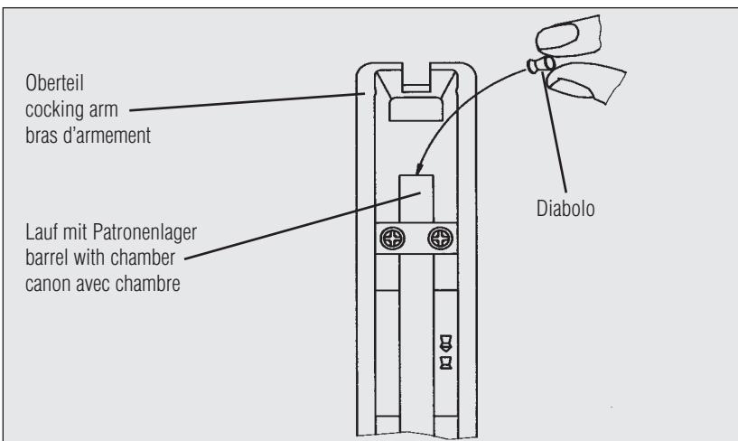
Verwenden Sie **nur** Diabolo-Kugeln und **keine** Stahlbolzen/-pfeile, Rundkugeln oder ähnliches. Achten Sie darauf, dass die Kugeln nicht beschädigt sind. Verwenden Sie keine gebrauchten Kugeln. Beachten Sie das jeweilige Kaliber Ihrer Waffe.
