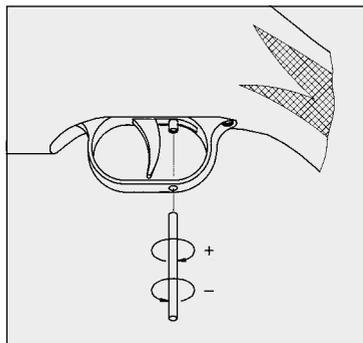
El peso de gatillo puede ser aumentado girando el tornillo a la derecha („+“) y reducido girando el tornillo a la izquierda („-“).
