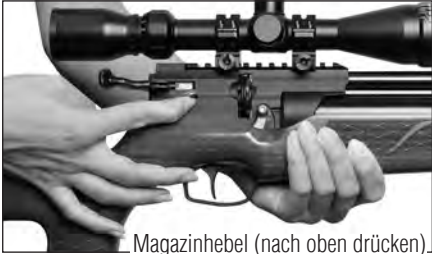
Magazinhebel (nach oben drücken) magazine lever (push upwards)
