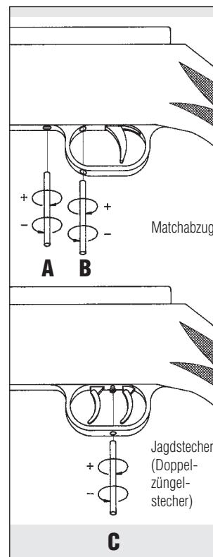
Stecher ist jetzt gesetzt. **Vorsicht:** Der Schuß kann jetzt bereits durch eine Erschütterung ausgelöst werden, wenn der Stecher zu leicht eingestellt ist.
