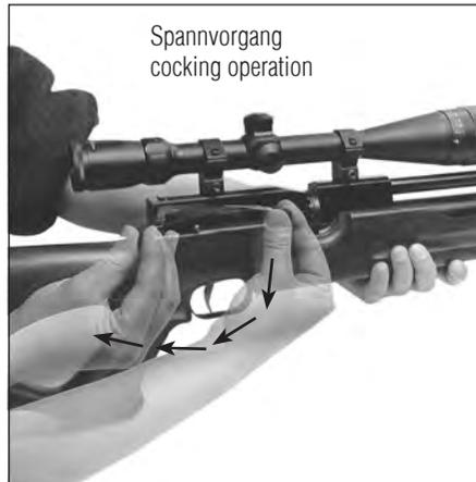
Während des Spann-, Lade- und Schließvorganges darf sich **kein** Finger, Kleidungsstück oder ähnliches am oder in der Nähe des Abzugs befinden. Halten Sie die Finger immer außerhalb des Abzugsbügels. Nur zum beabsichtigten Schuss darf der Finger an den Abzug gelegt werden. Tragen Sie **immer** eine Sicherheits-Schießbrille.
