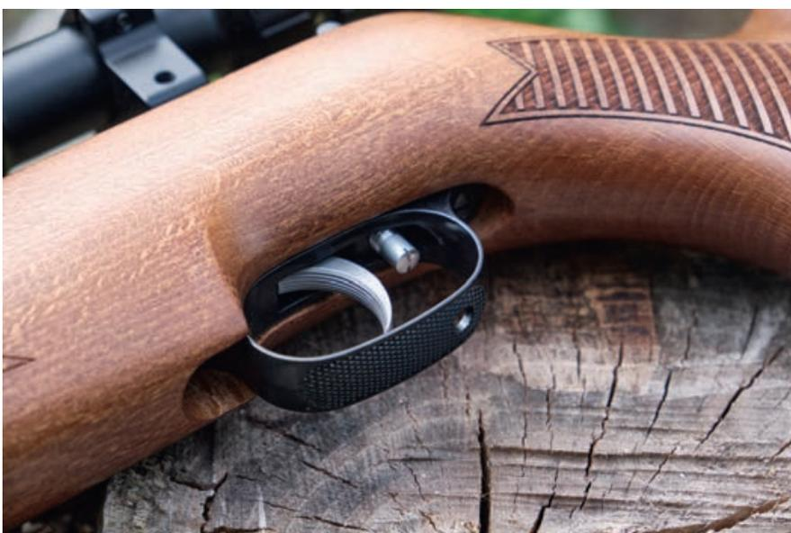
**Verstellbar:** Der Abzug des HW 80 SL-K ist verstellbar. Die Anpassung nimmt der Schütze über die Schraube hinter dem Abzugzüngel vor.
