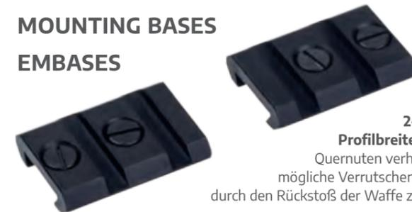
2-teilig mit Profilbreite 21,5 mm. Quernuten verhindern das mögliche Verrutschen der Ringe durch den Rückstoß der Waffe zuverlässig.
