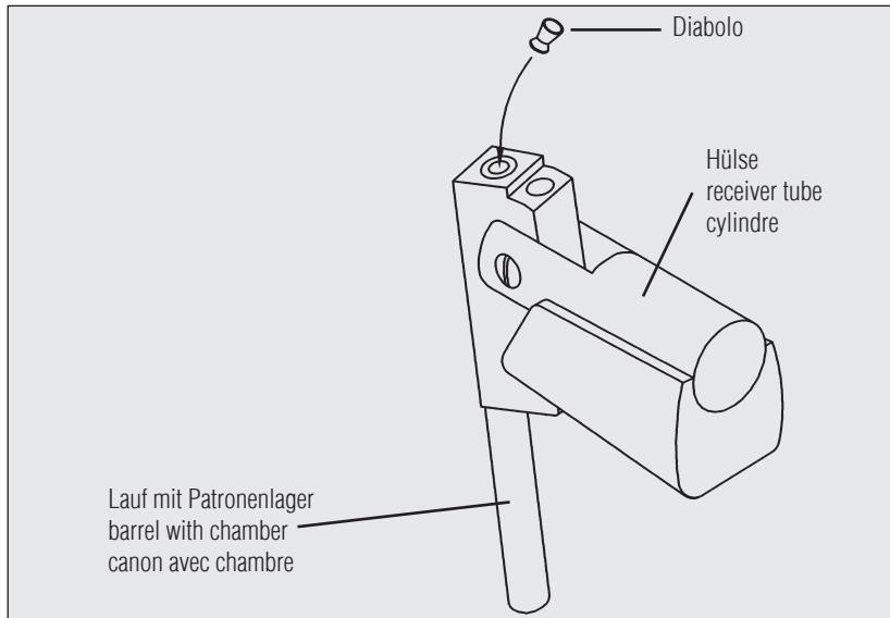
Verwenden Sie **nur** Diabolo-Kugeln und **keine** Stahlbolzen / -pfeile, Rundkugeln oder ähnliches. Achten Sie darauf, dass die Kugeln nicht beschädigt sind. Verwenden Sie keine gebrauchten Kugeln. Beachten Sie das jeweilige Kaliber Ihrer Waffe.
