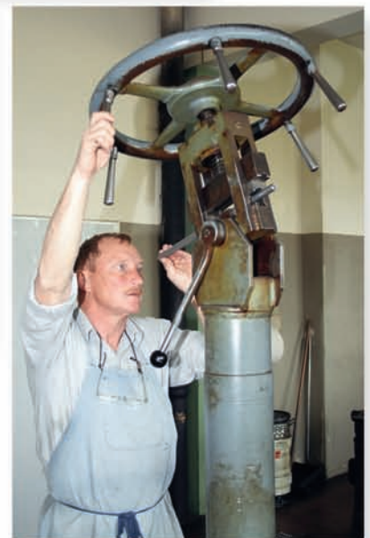
Ganz oben: Jedes Gewehr wird vor der Auslieferung sorgfältig montiert und getestet. Darunter: Stefan (l.) und Hans-Hermann Weihrauch (r.) zeigen Dr. Schulze Wilbrenning die aus drei Teilen zusammengeschweißte Systemhülse. Rechts: Weihrauch-Läufe werden im eigenen Haus gezogen und dann "mit Augenmaß" gerichtet.
