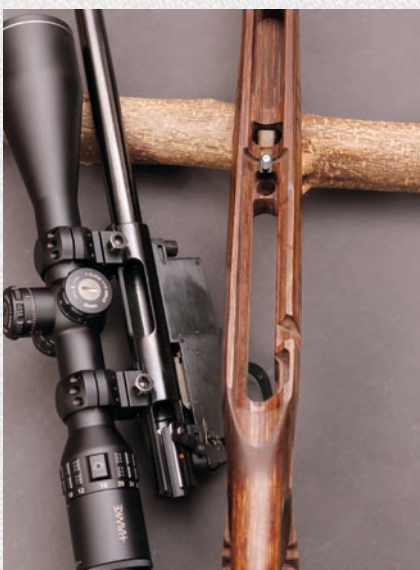
Zerlegt: Im Inneren sieht man die zum Verbinden von System und Schaft nötigen Teile Stahlblock / Zapfen.
