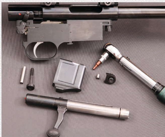
Alles auseinander: System und Lauf mit fest montierter Magazinschacht-/Abzugseinheit, Magazin, beide Systemschrauben, Pillars, unten der Verschluss mit den zwei Riegelwarzen.
